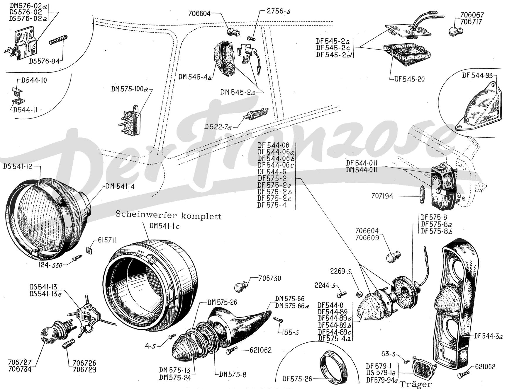
50 - SCHEINWERFER - BELEUCHTUNG - BLINKER - RÜCKLICHT - STOPLICHT - USA
