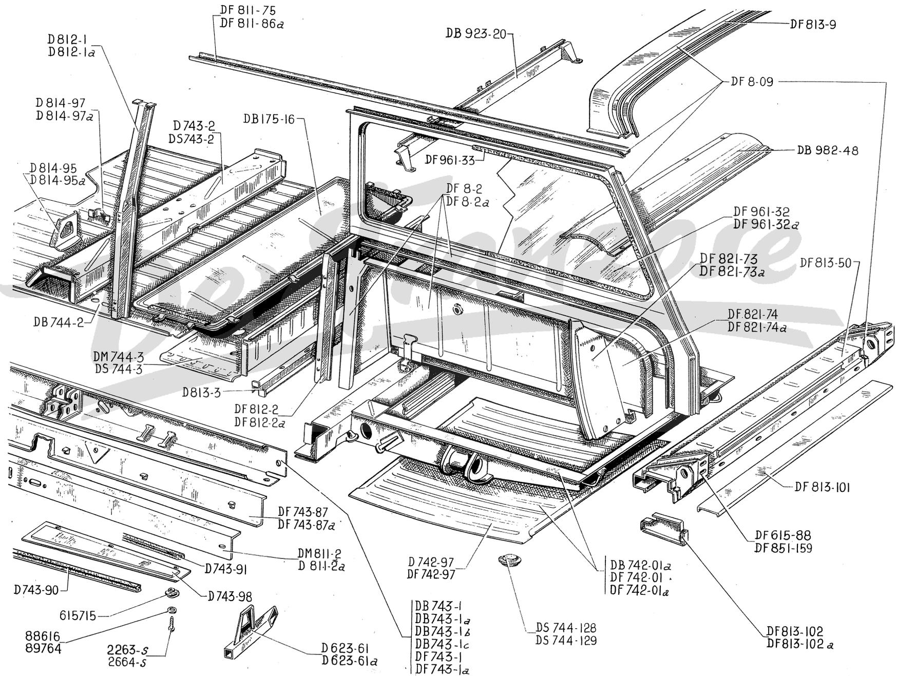
72 - KAROSSERIETEILE (HINTERER WAGENKASTENTEIL)
